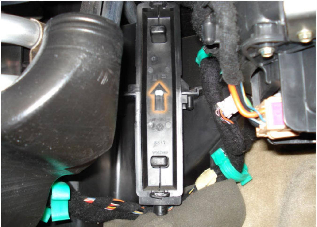
Zeigen die Flussrichtung (Flow) des Filters beachten, der Pfeil muss Richtung Sitz (Fahrzeug Heck)
